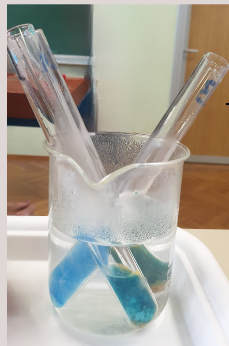
slika 2. epruvete sa zadanim uzorcima nakon kapanja Fehlingove otopine se nalaze u posudi s vrućom vodom
