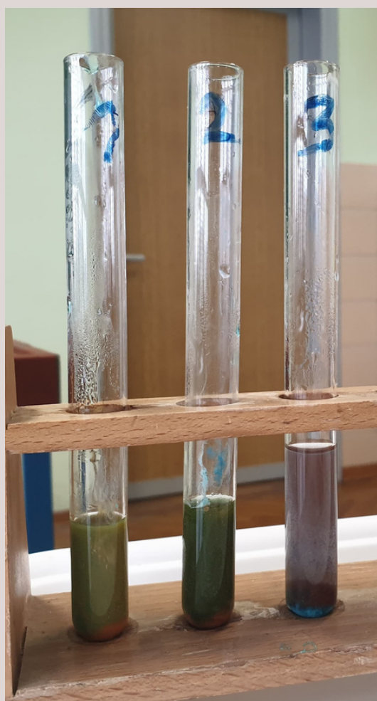
slika 3. i 4. Rezultat boja i taloga epruvetama s uzorcima nakon vađenja epruveta iz vruće vode.
